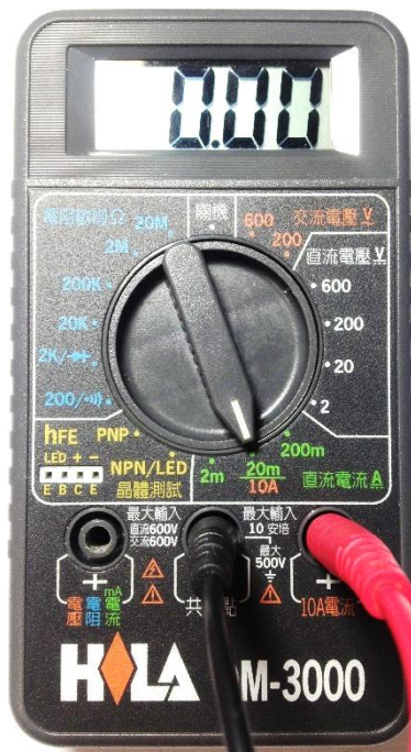
多功能電表:較大電流(>200mA)測量時的旋鈕位置與接線插孔
