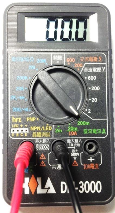
多功能電表:直流電流測量時的旋鈕區域與接線插孔
