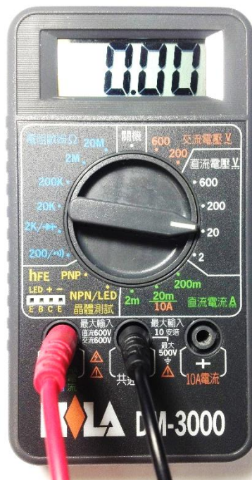
多功能電表:直流電壓測量時的旋鈕區域與接線插孔
