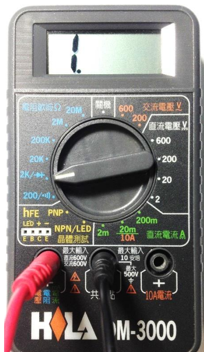
多功能電表:電阻測量時的旋鈕區域與接線插孔
